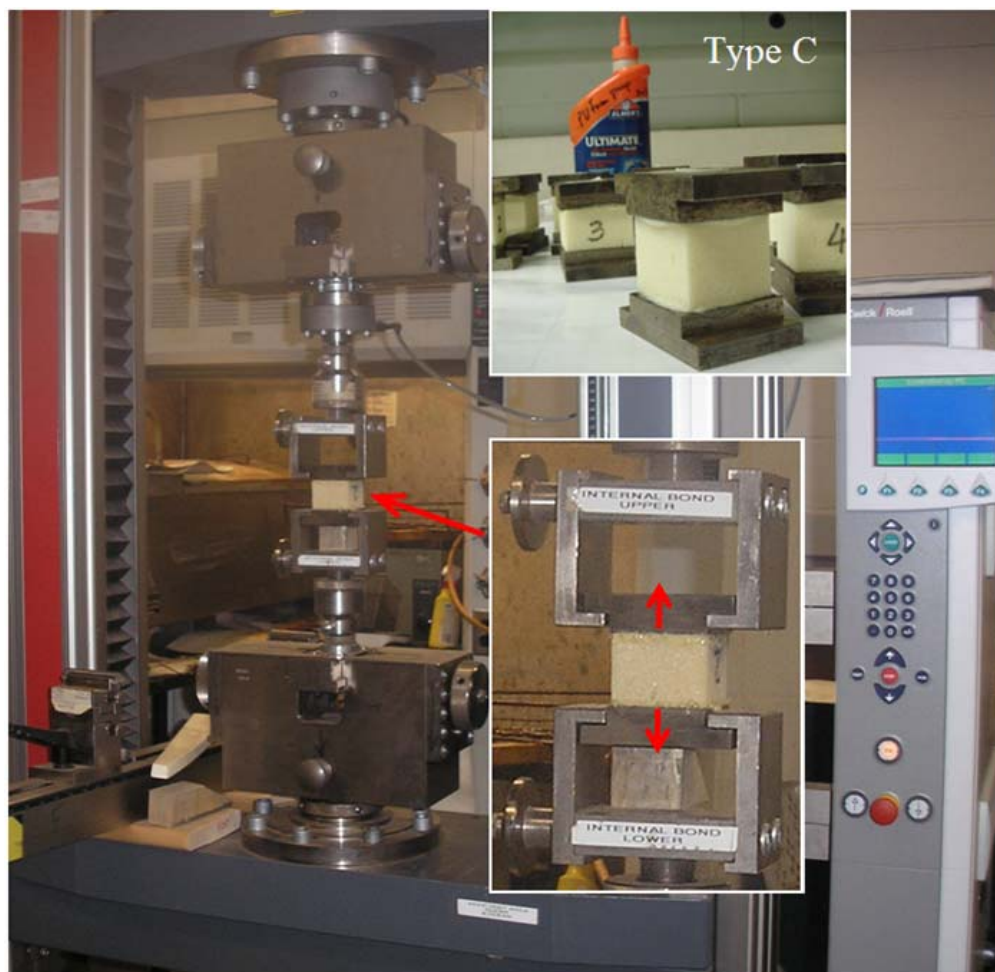
Fig. 1. Tensile test of PU spray foams
