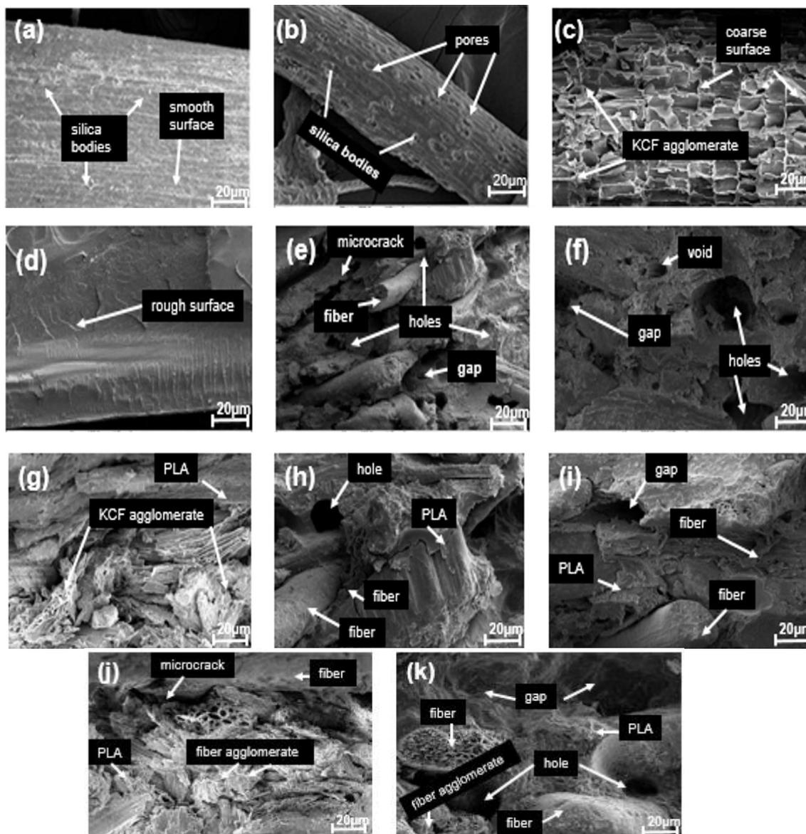
**Fig. 13.** SEM micrographs of (a) EFBF, (b) OPMF, (c) KCF, (d) neat PLA, (e) EFBF-PLA, (f) OPMF-PLA, (g) KCF-PLA, (h) EFBF/KCF(55%:5%)-PLA, (i) OPMF/KCF(55%:5%)-PLA, (j) EFBF/KCF(50%:10%)-PLA, and (k) OPMF/KCF(45%:15%)-PLA
