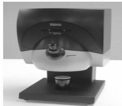
Fig. 2. Elrepho Spectrophotometer
