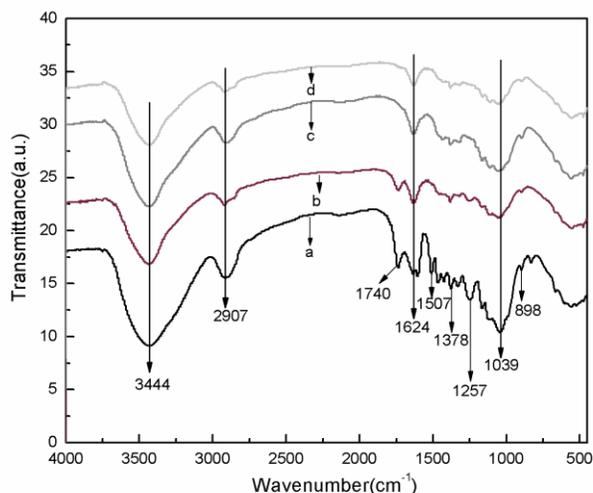
**Fig. 3.** FTIR spectra of the original particles (a), holo-cellulose (b),  $\alpha$ -cellulose (c), and CNFs (d)
