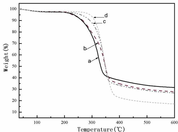
**Fig. 5.** TG curves of (a) the original material, (b) holo-cellulose, (c)  $\alpha$ -cellulose, and (d) CNFs
