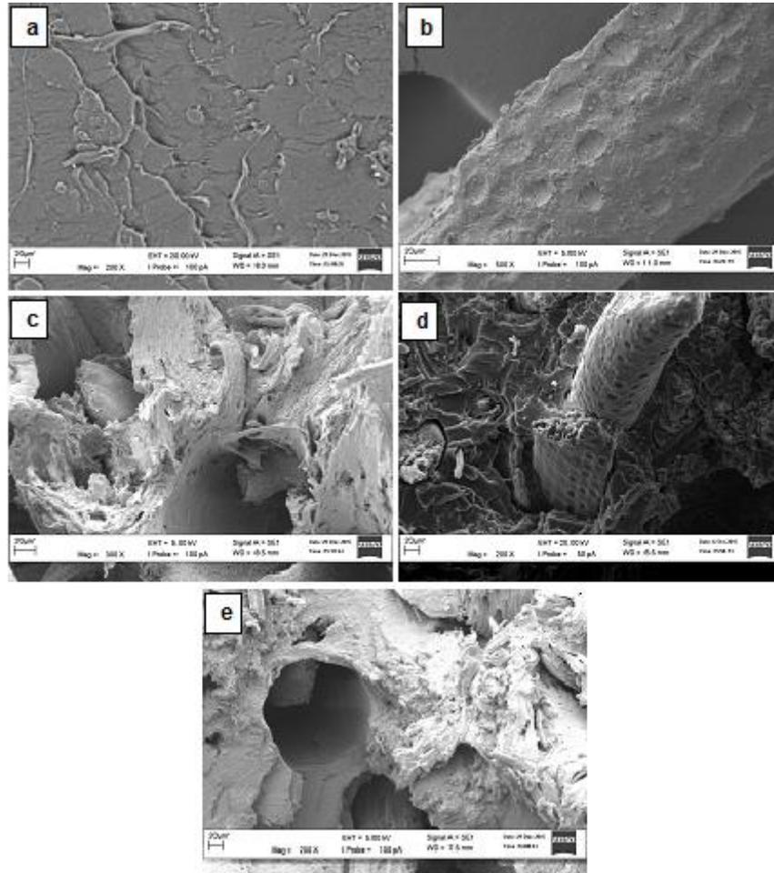
**Fig. 9.** SEM of (a) pure TPU, (b) SPF, (c) 160  $\mu\text{m}$  TPU-SPF, (d) 250  $\mu\text{m}$  TPU-SPF, and (e) 425  $\mu\text{m}$  TPU-SPF
