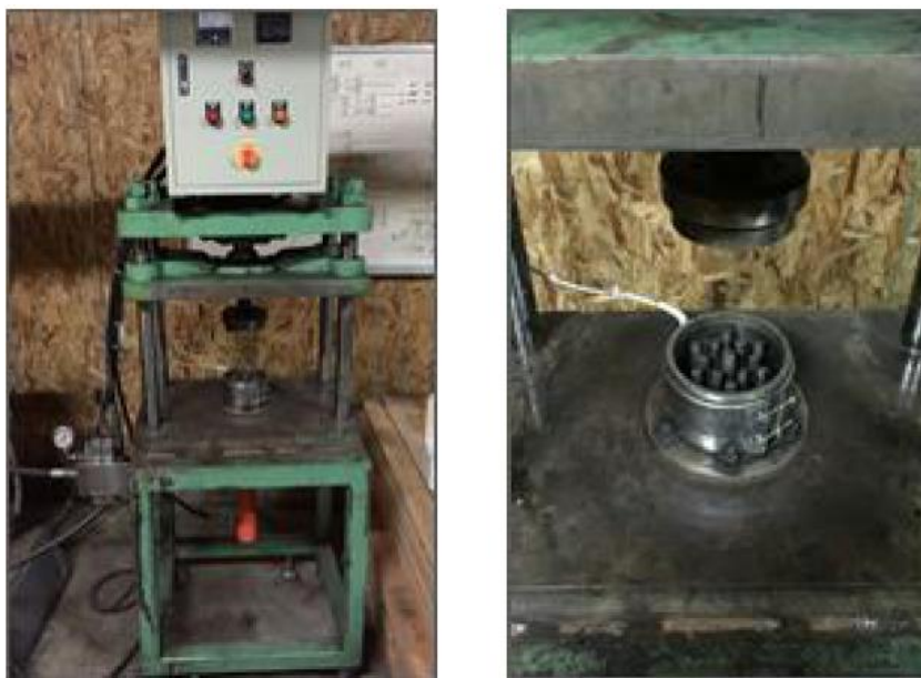
Fig. 2. Mold press (lab scale)
