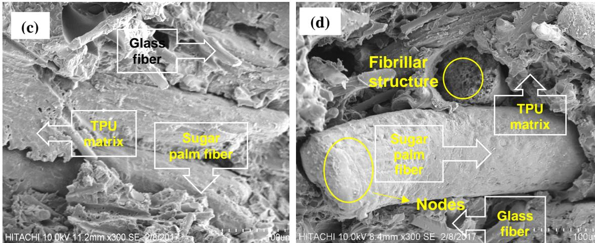
**Fig. 3.** SEM pictures of (a) UTSP, (b) TNSP), (c) TSSP), and (d) TNSSP
