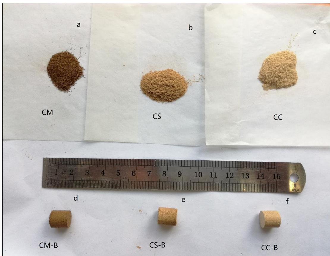
**Fig. 1.** Experimental sample: (a) raw CM, (b) raw CS, (c) raw CC, (d) CM-B, (e) CS-B, and (f) CC-B
