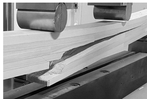
(d) Diagonal crack
