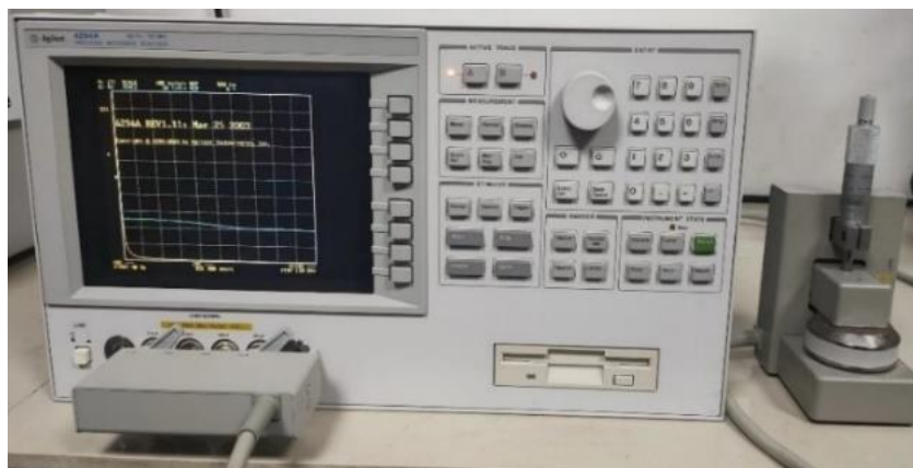
Fig. 6. Dielectric parameter test system
