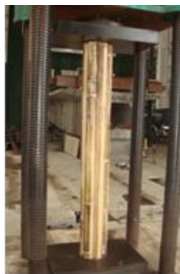
Fig. 10. Longitudinal compressive strength test
