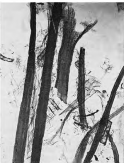
(d) Spruce sulphite pulp beaten 72 min in Lampén mill, lightly silvered ( \times 140 )
